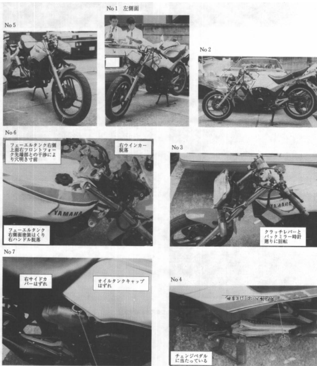
写真5-7 自動二輪車の被損状況
