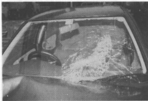
写真5-19 直進車のフロントガラスの被損状況
