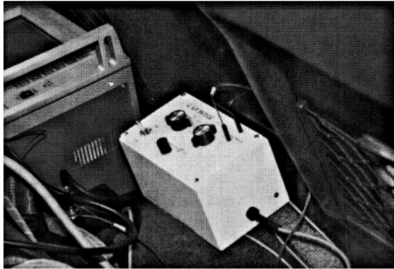
写真 4－2－2 GSRブリッジボックス
