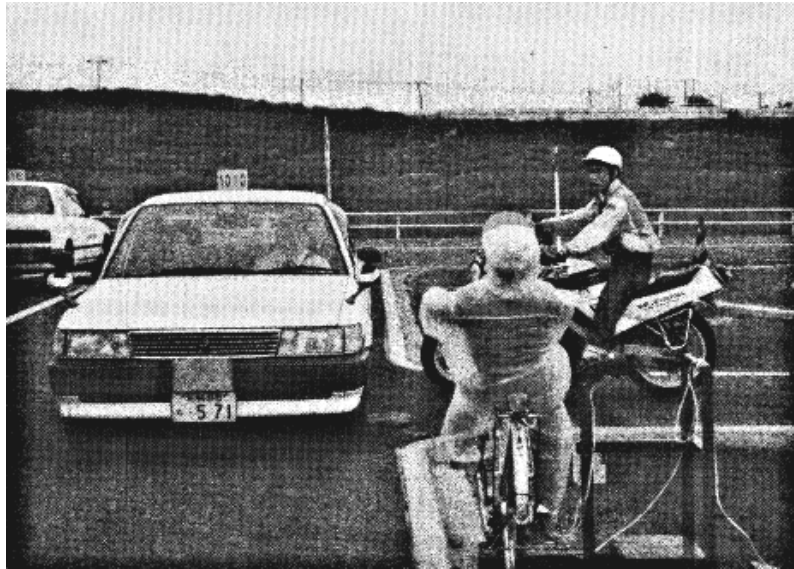
写真 2 - 3 - 6 ふらふら自転車(前方から飛び出し人形と同様リモコンにて操作)
