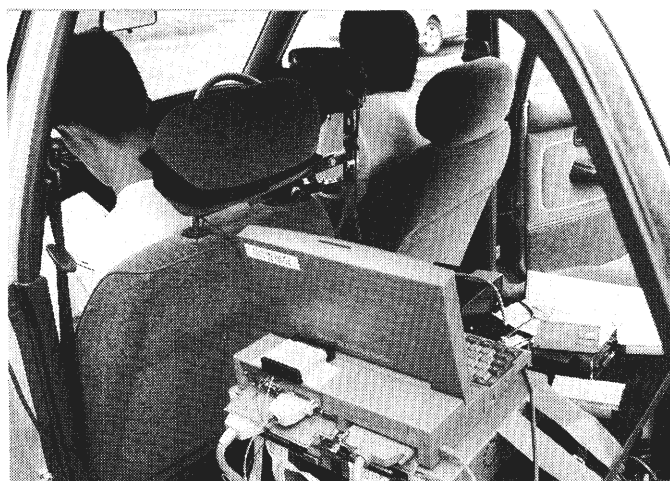
図 1-2-2-10 車載パソコン、アンプ類
