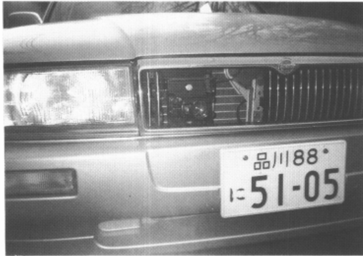
図 1-2-2-11 車両フロントグリルに取り付けられた車間距離計
