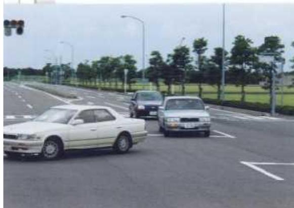
被験車は前後に車両を配置したサンドイッチ状態で走行し、先行車両のブレーキングに追隨してブレーキをかけさせ、その反応を測定した。
