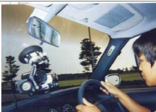
視線の移動状況の測定は、車内に設置した CCD カメラによりビデオテープに撮影したものを分析して行った。
