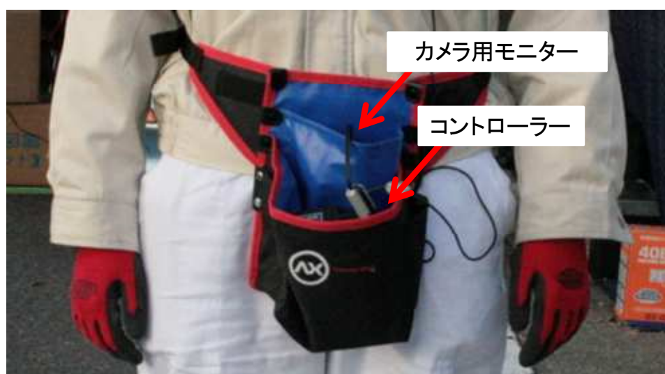
図 16 アイマークレコーダーコントローラー収納部
