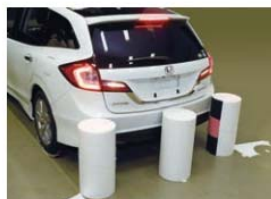
図 4-5 後方視界情報の試験方法 2)
