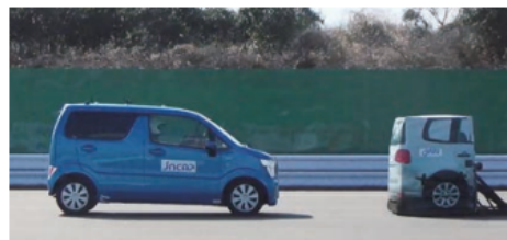
図 4-2 被害軽減ブレーキ（対車両）の試験方法 2)
