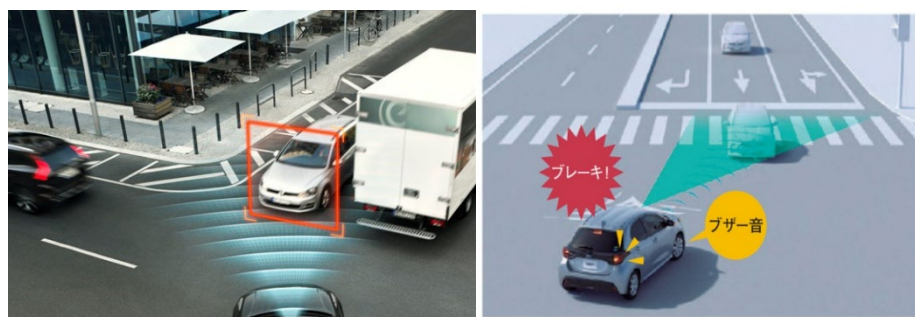
図 1.6 交差点対応の緊急自動ブレーキシステムの商品化の例
