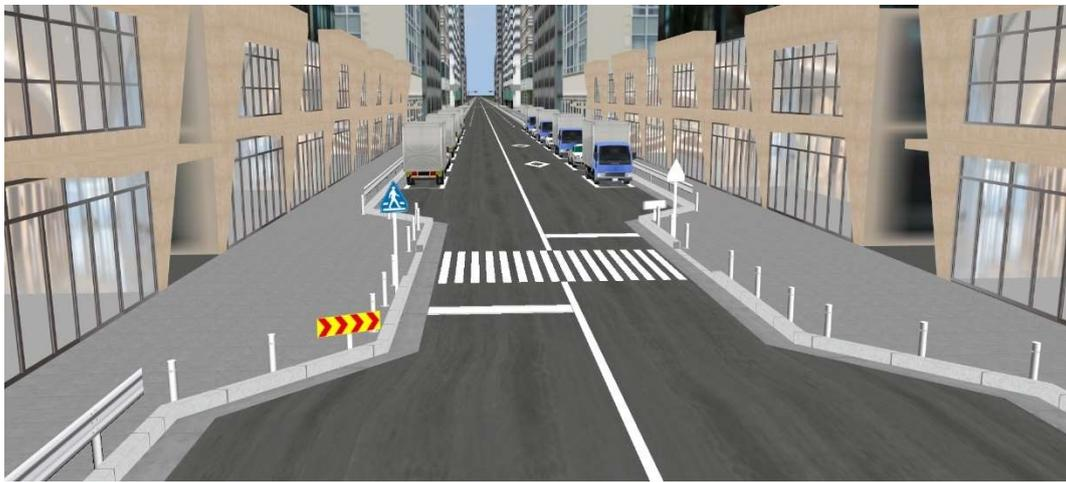
図 3-36 バルブアウト型横断歩道(パターン 5)の駐車車両の様子
