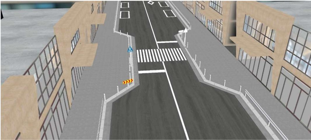
図 3-14 バルブアウト型横断歩道(パターン 5)の外観図
