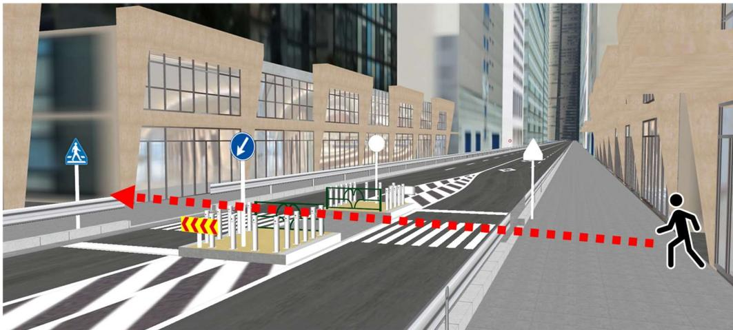
図 3-74 二段階型横断歩道(パターン3)のルート外観図
