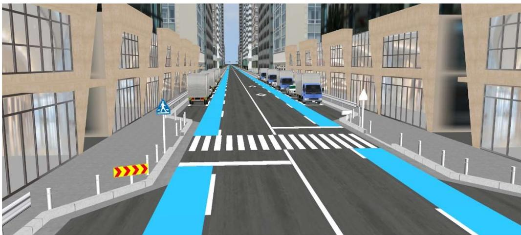
図 3-37 バルブアウト型横断歩道(パターン 6)の駐車車両の様子
