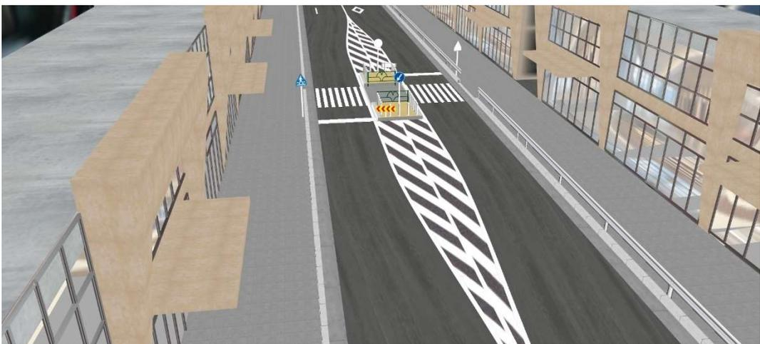
図 3-12 二段階型横断歩道(パターン3)の外観図
