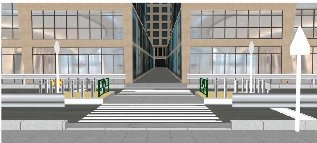
図 3-68 歩行者目線における二段階型横断歩道(パターン 3)の外観図
