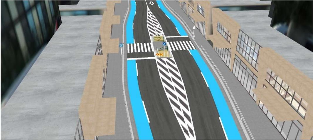
図 3-13 二段階型横断歩道(パターン 4)の外観図
