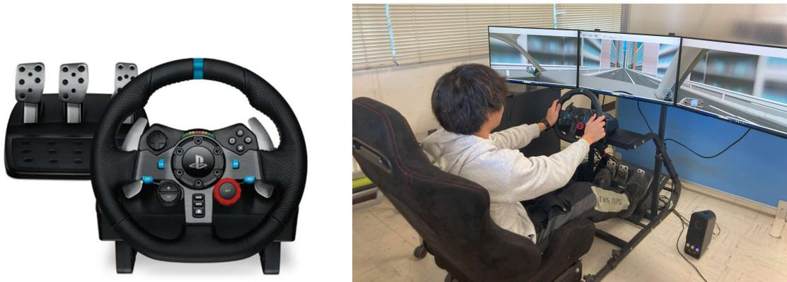
図 3-1 DS 機材(左：ハンドル・ペダル<sup>37)</sup>、右：全体図及び実験の様子(筆者撮影))
