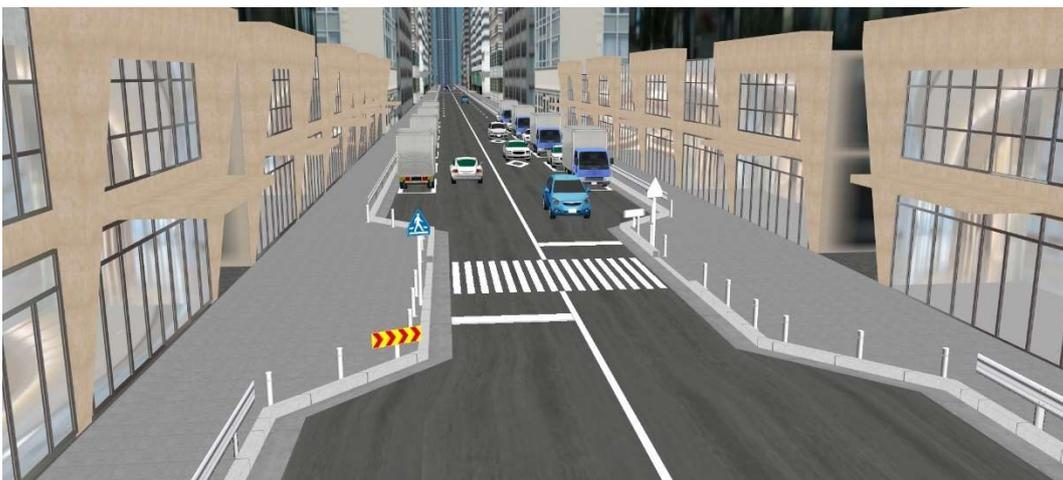
図 3-82 バルブアウト型横断歩道(パターン5・駐車車両あり)での接近車両の様子
