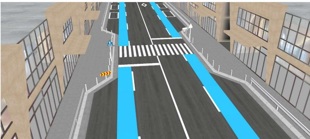
図 3-15 バルブアウト型横断歩道(パターン 6)の外観図
