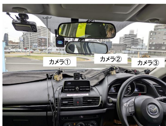
図 21 視線計測システム(Smart Eye Pro DX システム)
