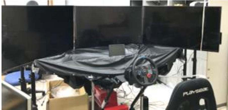
図 5 シミュレータ教育に使用するドライビングシミュレータ(3画面)
