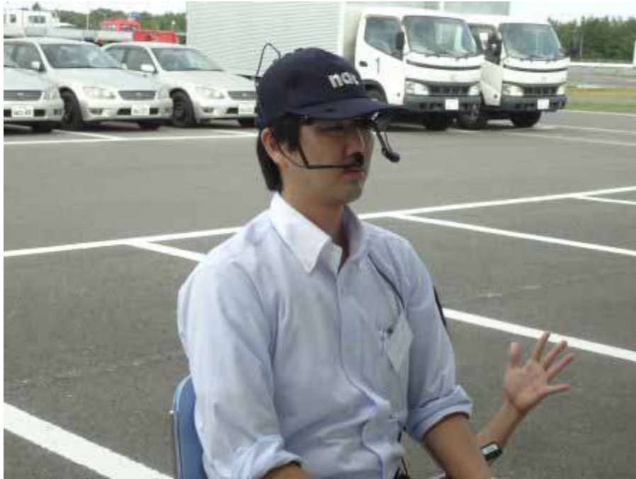
図 2-5 視線計測器を用いたキャリブレーションの様子
