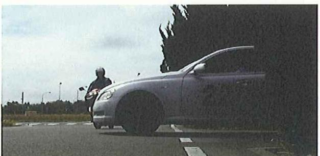
四輪車は、外側線手前で一時停止した後に、視界確保のため前進する。二輪車は車が飛び出してくることを予測していないため、スピードを緩めることなく交差点に進入し衝突する。
