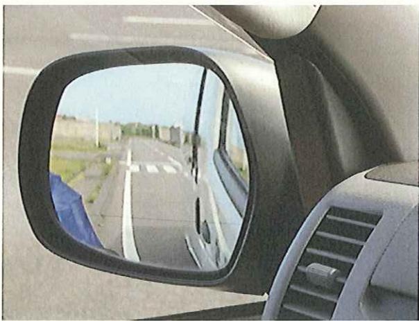
四輪車が左折をするために、バックミラーを確認後、ドアミラーを確認。写真ではライダーの肩が少し見えているが、見落としてしまう。車幅がさらに広い場合は、ドアミラーから完全に姿が見えなくなってしまう。
