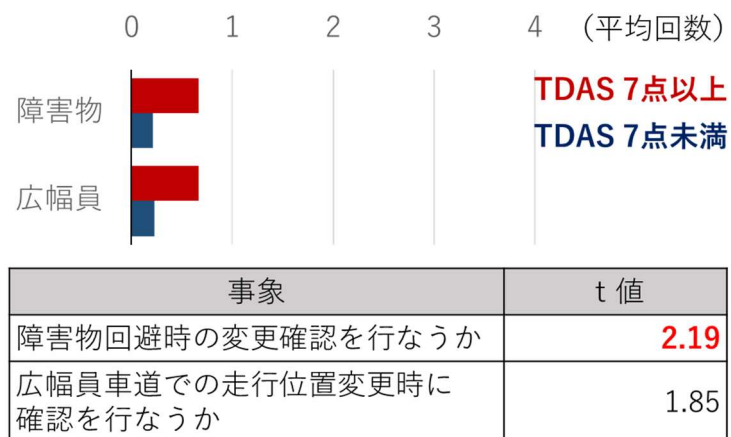
図-23 障害物回避時と広幅員車道での走行位置変更時に確認を行なう平均回数の比較
