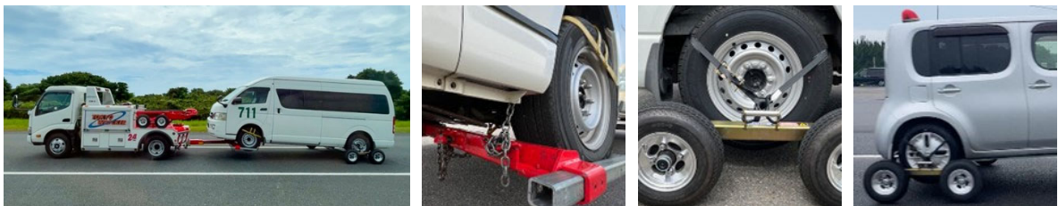
図 牽引の様子（左）、レッカー車と被牽引車の固定状況（左中）、被牽引車の後輪とドリーの固定状況（右中）、回転灯の設置状況（右）
