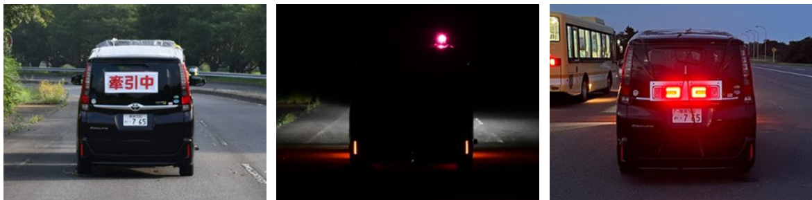
図 実験で使用した反射器具（左）、回転灯（中央）、取付制動灯（右）
