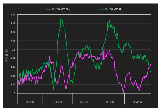
＜図 50 進入速度 20km/h の走行軌跡とズレ量（ミニカー 1）＞
