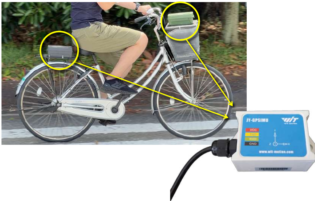
図 2. 6. 6 自転車に設置したジャイロセンサー
