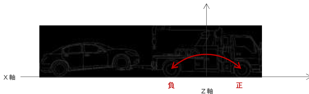
＜図４－１－３ X軸－Z軸平面で見た車両挙動のイメージ＞
