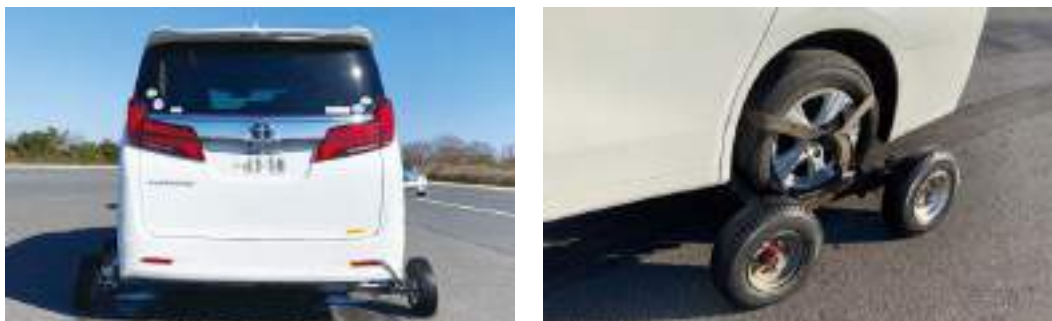
<図 3-4-3 被牽引車後輪にドリーを装着した状態>
