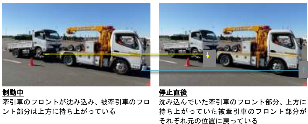
<図 4-6-2-5 急制動時の目視による車両挙動の確認結果>
