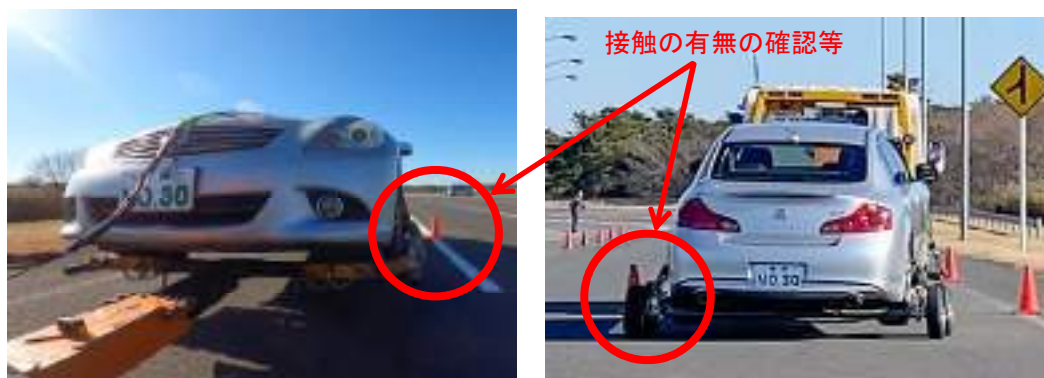
<図3-4-7 目視による車両の挙動や障害物との接触の有無等の確認>
