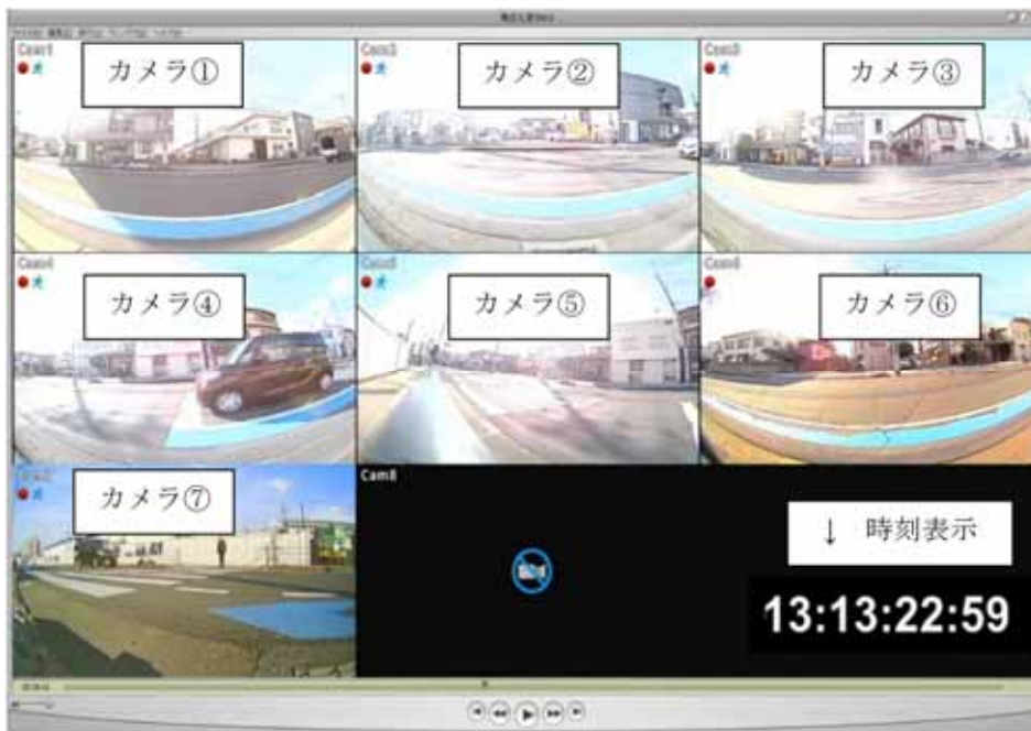
図 2-2-8 自動車の通過時刻読み取り画像の例(各カメラの合成映像)
