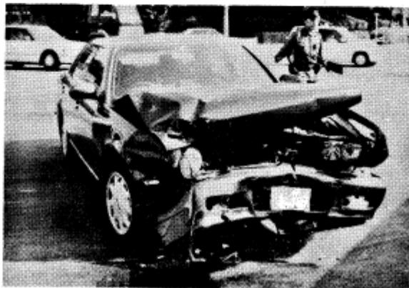
写真 5 - 4 - 8 事故現場における車両の変形状況
