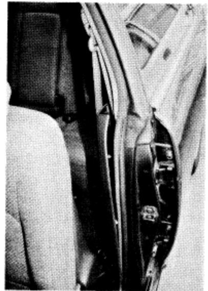
写真5-4-12 事故車両Bの室内の変形状況
