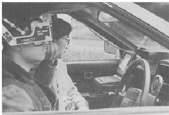
写真3-4-3-4 アイマークレコーダの調整(旧モデル)
