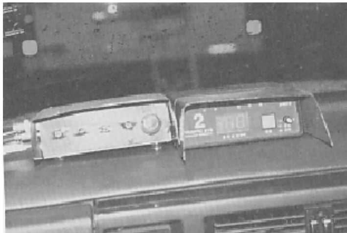
写真 3-4-2-3 ダッシュボード上に取り付けたトラフィックアイのディスプレイユニット(右)とイベントマーカのランプ部(I)(左)
