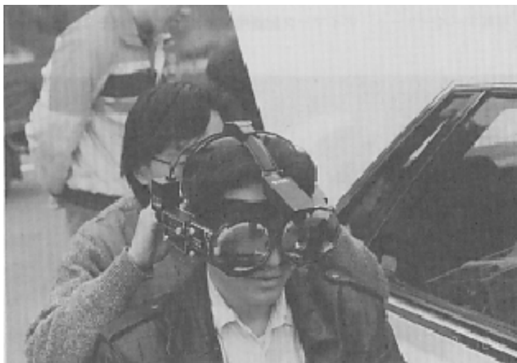
写真3-4-3-1 アイマークレコーダのヘッドユニット(新モデル)
