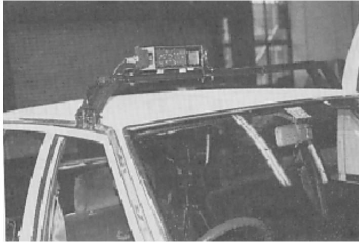
写真 3-4-2-2 屋根に取りつけたトラフィックアイ(車間距離計測器)のレーザーレーダヘッド部
