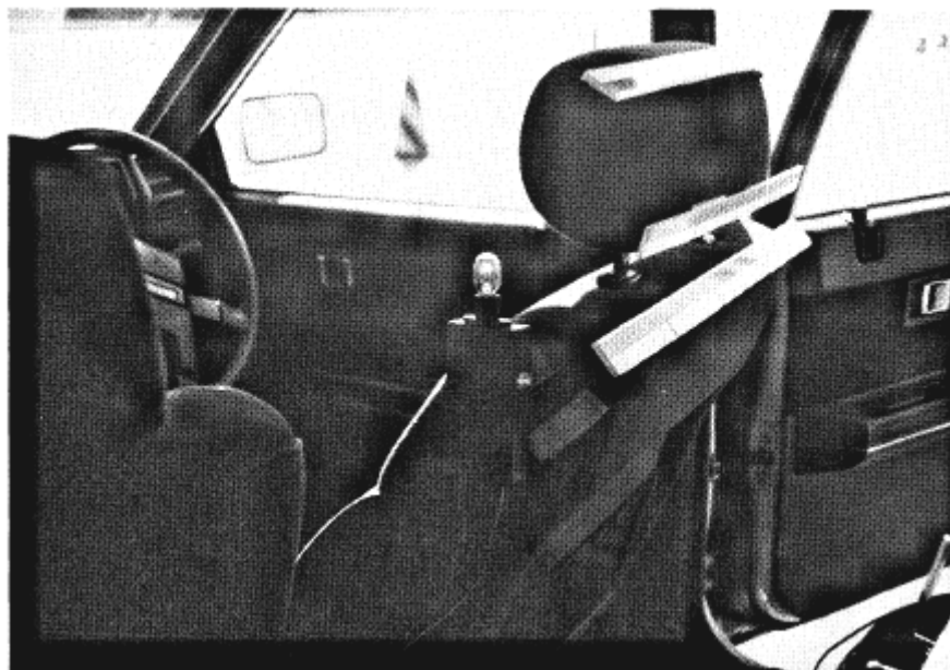
写真3-7 イベントマーカーランプ設置状況
