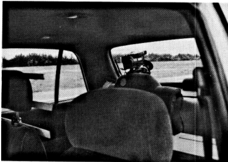
写真3-3 左右振れ測定用ビデオカメラ設置状況
