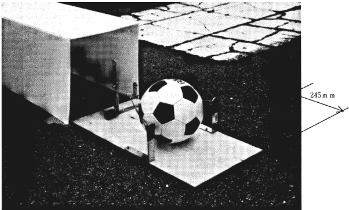
図1-3-17 ボール飛び出し装置（内部）
