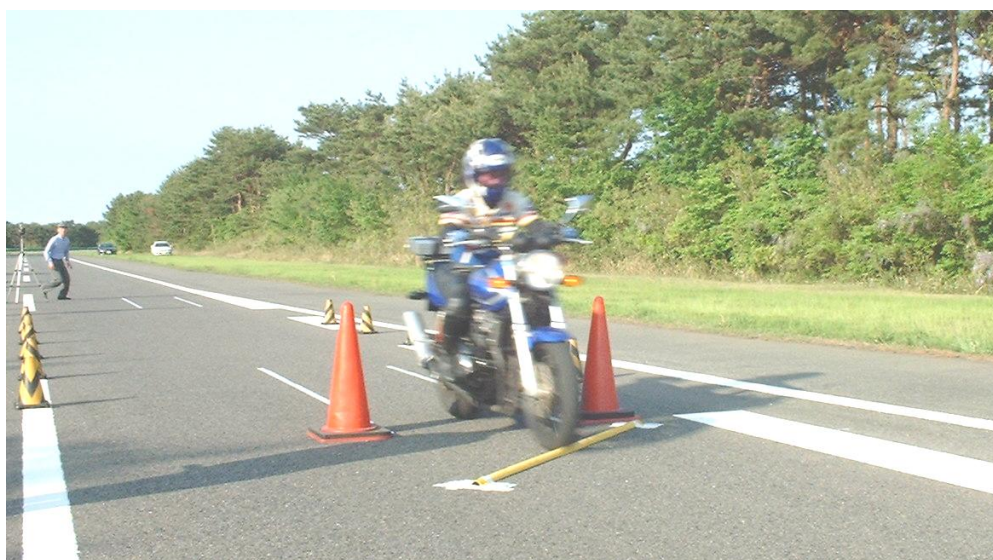
図 1－3－15 突起乗越し実験の状況
