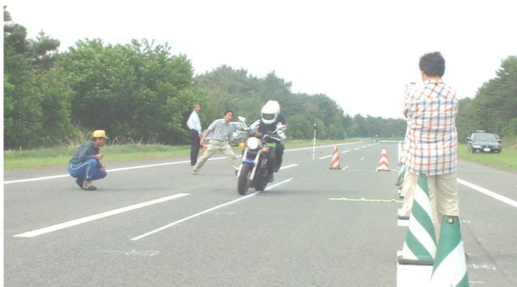
図 1-3-13 車線乗移り実験の状況
