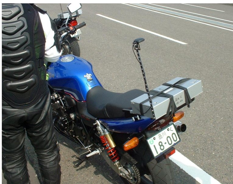
図 1 - 8 - 1 車両挙動測定機器
