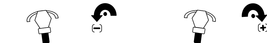
図 1 - 8 - 4 ロールレート （二輪車の進行方向に向かって後方から見た図）
