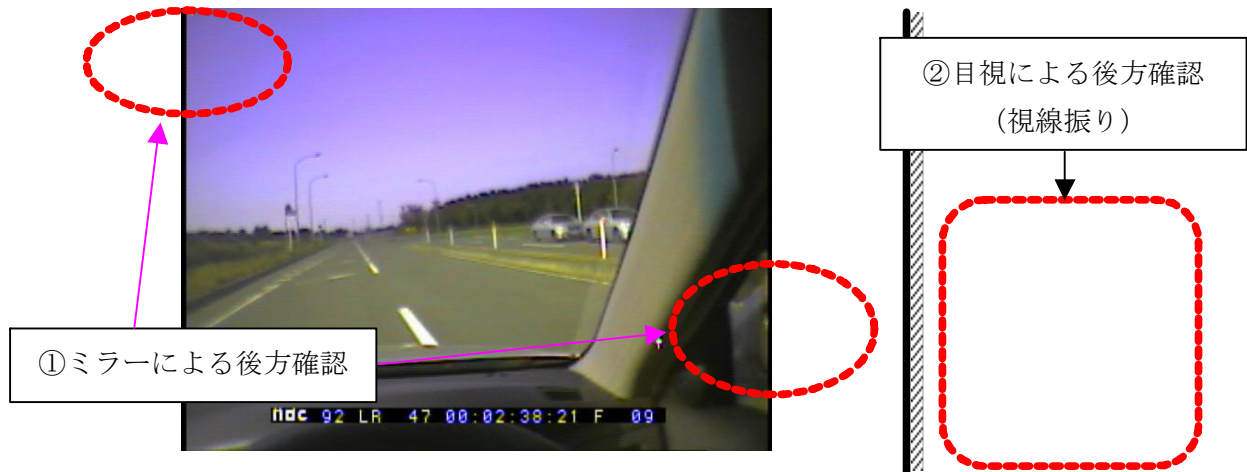
図 3-5-2 車線変更時後方確認状況の把握箇所
