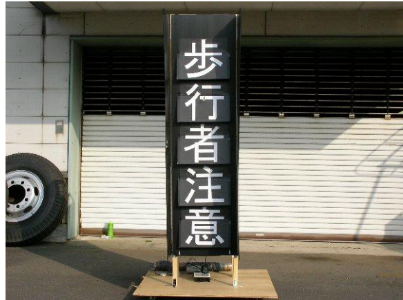
図 2-6-3 白抜き文字式情報板
