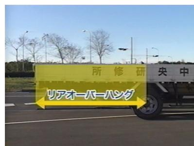
右の写真は右折時に車両左側のリアオーバーハングによるせり出しが後続車に接触しそうになっている危険な場面です。
