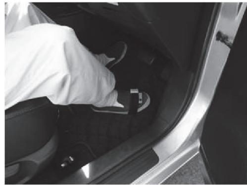
図2-5 運転技能自動評価システム設置状況（右足位置）
