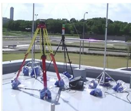
図 2-3-1 固定基地局設置状況
