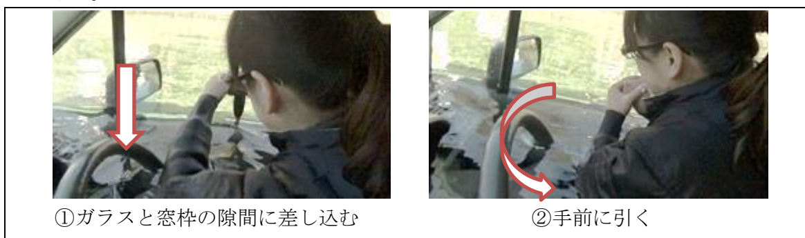
2-1-5 2 テコの原理を使った破壊手順
