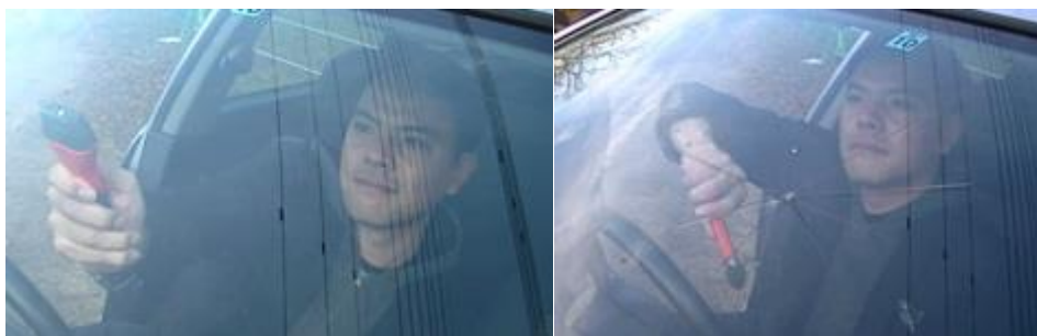
2-1-9 8 緊急脱出用工具によるフロントガラスへのインパクト
