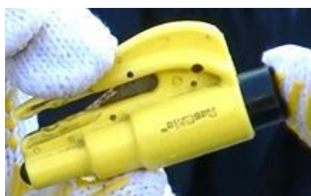
2-1-4 9 カッター部分の錆
