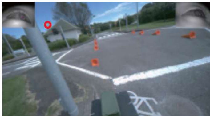
図4 通話条件における交差点進入時の注視点（赤丸で示す部分）
