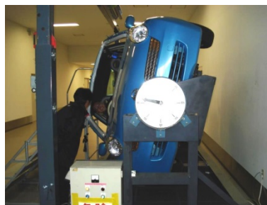
ロールオーバーシミュレーター利用の転倒車両脱出実験
