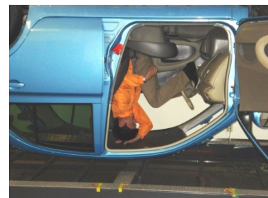
ロールオーバーシミュレーター利用の転倒車両脱出実験
