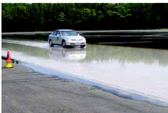
摩擦係数の異なるタイル舗装面に散水することにより、雪道や凍結路と同じような滑る路面を人工的に作ります。
